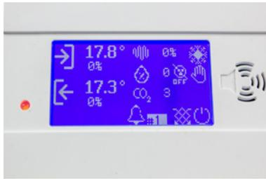
Este mando de pared puede gestionar hasta **32 recuperadores de calor ASPIRNOVA serie RCE-EC-DP** a través de una conexión en serie utilizando el protocolo Modbus RTU, a través del puerto RS485, disponible tanto en los recuperadores como en el mando. Además, gracias a la conectividad mediante Modbus, estos equipos pueden integrarse en sistemas de gestión BMS para una regulación superior.
