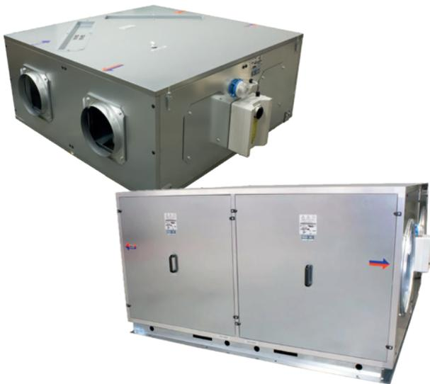
La serie de recuperadores de calor **ASPIRNOVA RCE-EC-DP** está disponible en versiones tanto horizontal como vertical. En ambas configuraciones, los equipos están fabricados con paneles sándwich aislados de 25 mm, usando poliuretano (PU) o lana mineral. A partir del modelo RCE 7100, se añade una estructura tubular de aluminio extruido para mayor robustez.
