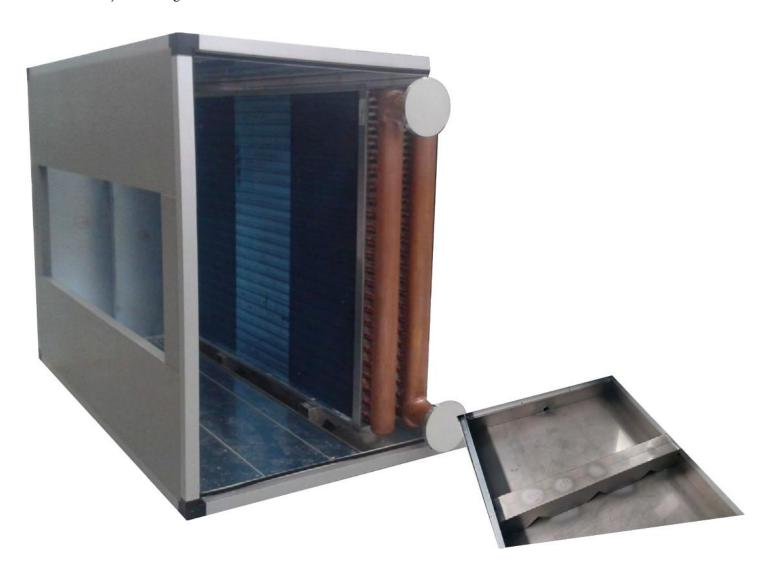
La humectación se basa en el principio natural de evaporación del agua por una corriente de aire, como sucede continuamente en la naturaleza. El aire que pasa por una lámina de agua la evapora parcialmente incorporando el vapor de agua a su composición y paralelamente se enfría puesto que la energía necesaria para la evaporación la aporta el propio aire.
